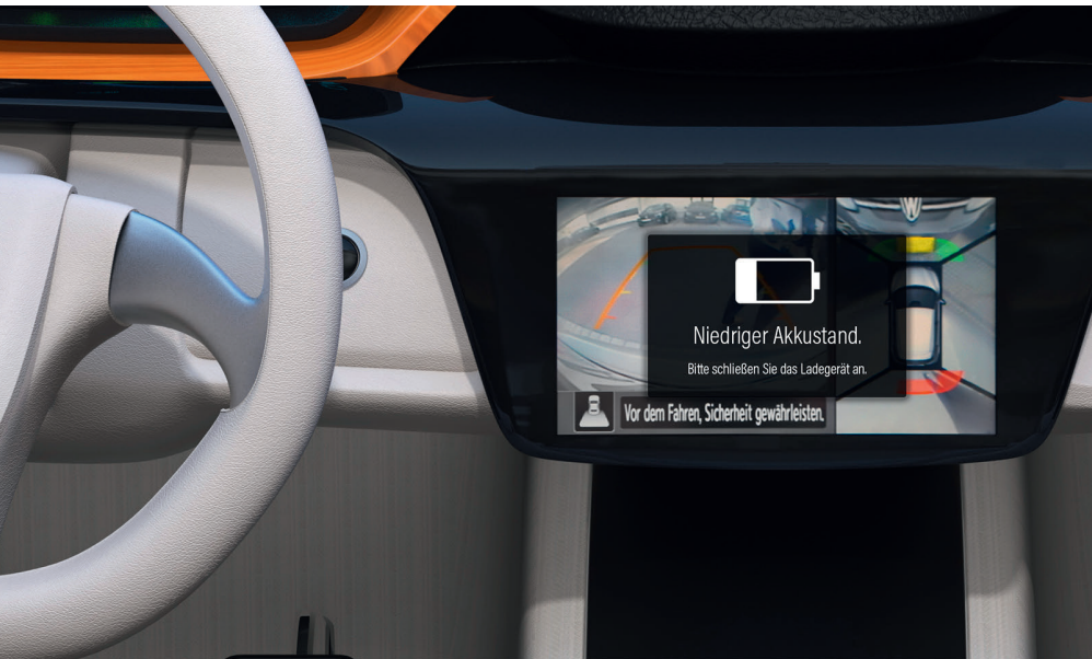
Bild 2: Unerwünschte Querwirkungen wie ein Hinweis zu niedrigem Akkustand während der Rückwärtsfahrt. © ASAP
